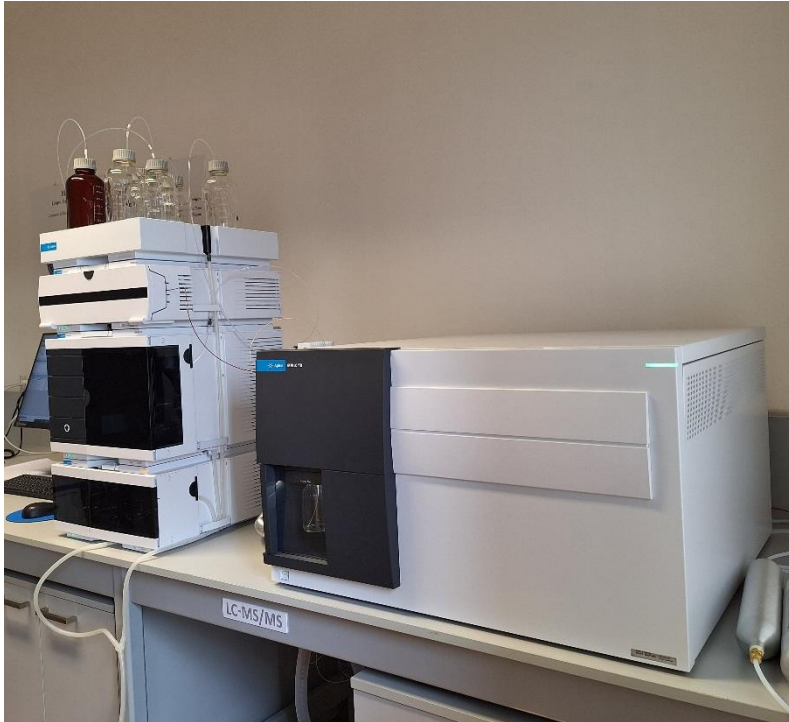
Strumentazione LC-MS/MS – HPLC 1290 Infinity II Agilent – MS/MS 6470 LC/TQ utilizzata per la determinazione della melatonina nei Laboratori di Ricerche Analitiche del BSC- Cogollo del Cengio (VI).
